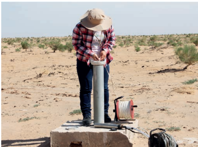
Хяналтын цооног дээрх газар доорх усны түвшинг хэмжиж байгаа нь
